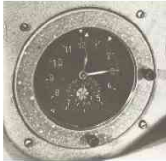
Рис. 14 Фото лицевой части экспериментального индикатора временного комбинированного – ИВК. На ИВК отсутствуют: индикатор времени полета и соответственно кремальера установки этого времени, риски установки индекса программ спуска.
