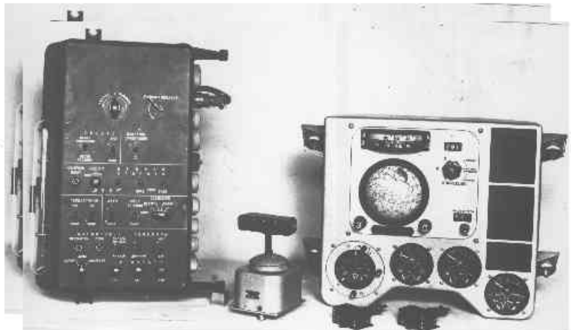
Рис.2 Система СИС-2-ЗКА корабля "Восток": пульт управления – ПУ-2-ЗКА, ручка управления РУ-1Б, приборная лоска ПД-2-ЗКА с новым индикатором местоположения
