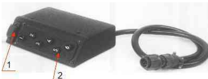
Рис.8 Фото электронного замка пульта космонавтов кораблей “Восток”. 2. Сменное кодирующее устройство. 3. 2. Кнопки набора кода, заданного кодирующим устройством
