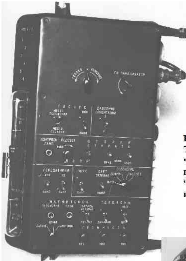
Рис.5 Фото пульта управления СОИ "СИС-1-3КА" корабля "Восток". В пульте применены самолетные тумблеры и кнопки, малогабаритные галетные переключатели. Специфической была ручка запуска часового механизма газоанализатора. Она поворачивалась до упора влево и затем под воздействием сжатой пружины в течение некоторого времени возвращалась в исходное положение. После этого на одном из приборов приборной доски индицировалось значение параметров атмосферы.
