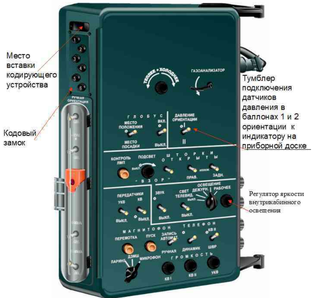
Рис.7 Графическая модель пульта управления СОИ “СИС-1-3КА” корабля “Восток”
